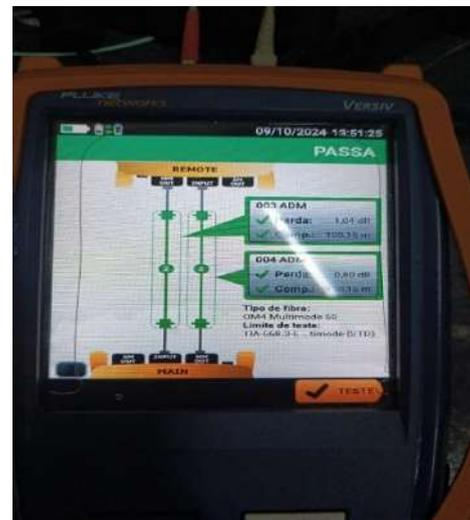
**FOTO 24:** Certificação MINI DIO com 3 vias de comunicação entre racks no prédio A da sala 7 a ADM.
